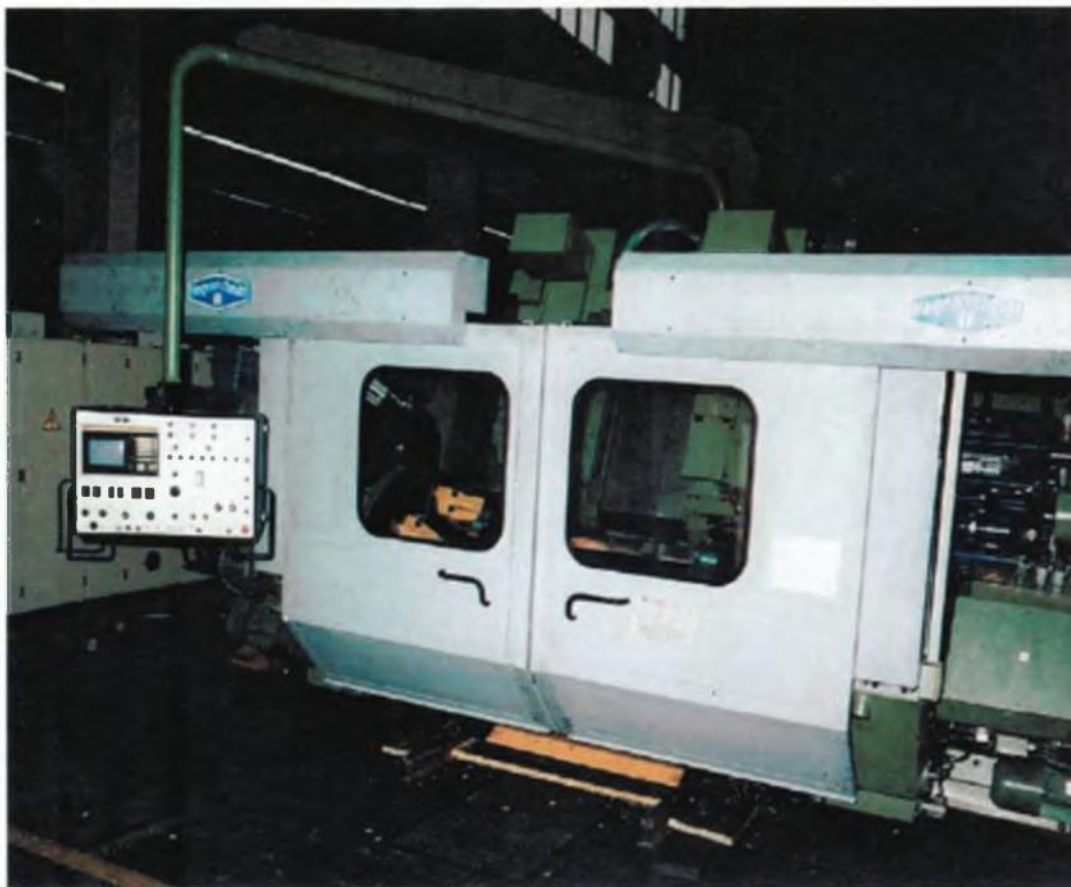
Портальный колесотокарный станок модели 165 с системой ЧПУ, которая управляет суппортами инструментов
