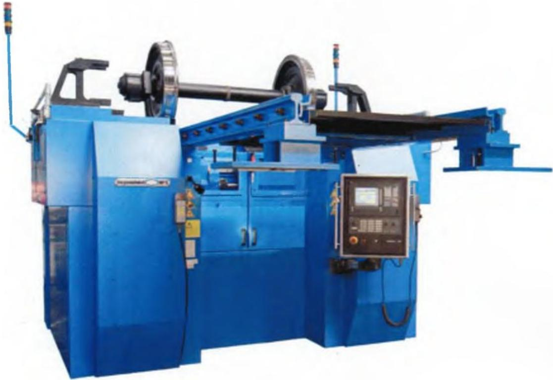
Станок с ЧПУ и автоматической измерительной системой
